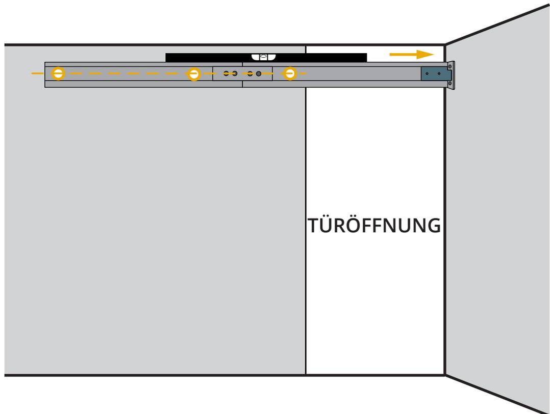
Heben Sie die Führungsschiene auf die zuvor ermittelte Höhe an. Führen Sie das Ende der Führungsschiene in das Loch am Seitenelement an der Wand ein.
