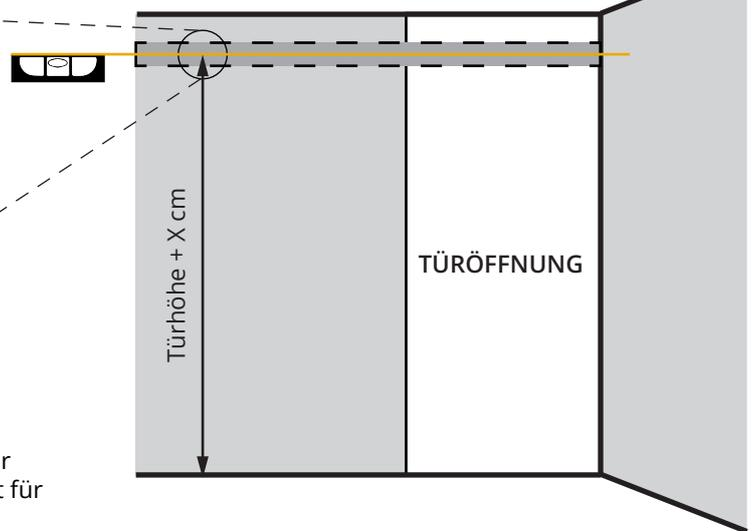
Die Höhe, in der die Führungsschiene montiert werden soll, wird durch Hinzufügen von X cm zur Flügelhöhe ermittelt. Überprüfen Sie den X-Wert für das entsprechende System oder Türmodell.
