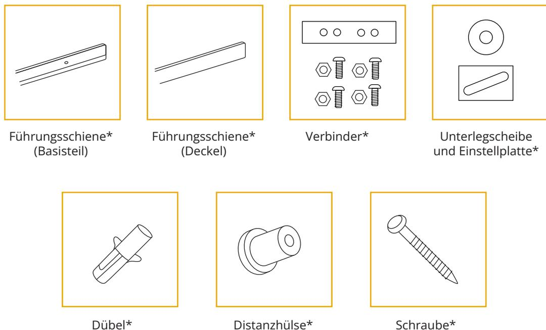
\* Die Anzahl der Schrauben/Hülsen/Verbinder/Einstellplatten/Schienenteile hängt von der Schienenlänge ab
