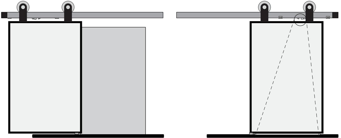
Am oberen Teil des Türrahmens, in der Nähe der Aufhänger, befinden sich vorgebohrte Löcher. Verwenden Sie sie, um die Auslöser zu installieren.
