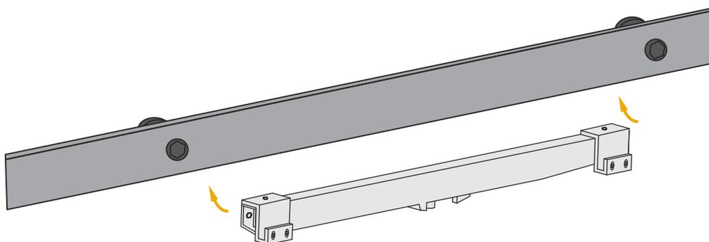
1. Installieren Sie die Soft Close auf der Rückseite der Führungsschiene am linken und rechten Ende. Die Soft Close wird zwischen den Befestigungsschrauben der Führungsschiene platziert.
